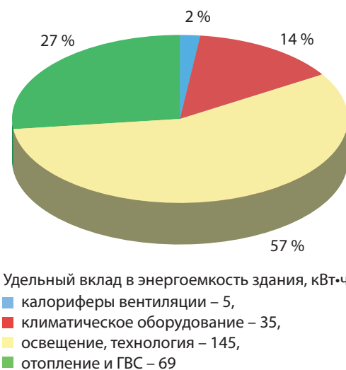
Рис. 4. Вклад в удельную энергоемкость от разных потребителей, кВт·ч/м² в год. Всего 254 кВт·ч/м² в год
